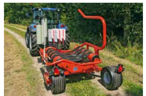
Небольшая транспортировочная ширина благодаря регулируемому положению колес
