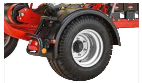
Большие грязеотражатели защищают пленку от повреждений при транспортировке
