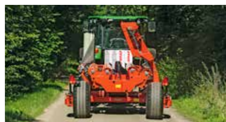
Для уменьшения транспортировочной ширины колеса можно сложить внутрь. В качестве дополнительного оборудования предусмотрен гидравлический привод для складывания колес
