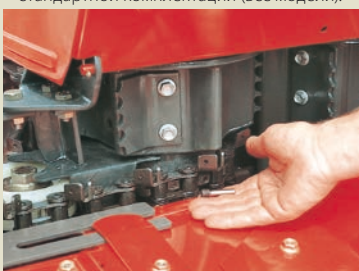
Дополнительная защита срезным болтом для принимающей цепи (MC 90 S TWIN и MC 180 S QUATTRO).
