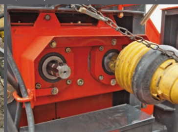
Два варианта ведущих валов для навешивания спереди или сзади.
