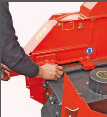
Простое заточивание ножа на месте.
