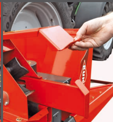
Очень удобный доступ к измельчающему диску.
