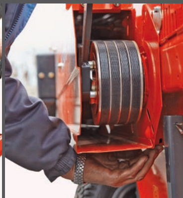
Измельчающий диск можно легко отрегулировать после заточивания ножей.
