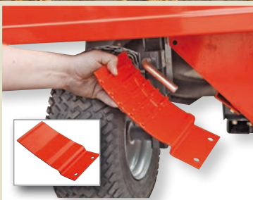
Гладкая и ребристая дробильные пластины (корм-крекер) в качестве стандартной комплектации (все модели).
