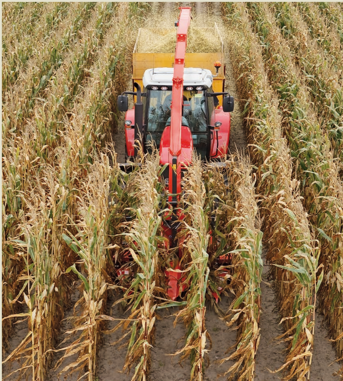
Дополнительное 80-см удлинение раструбы (MC 90 S и MC 90 S TWIN).
