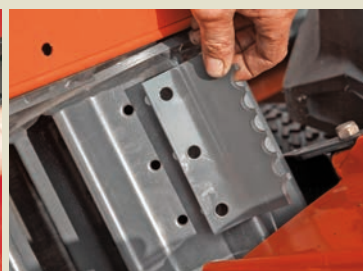
Дополнительный комплект приемных валков для скользкой или высокой кукурузы (стандартная комплектация для MC 180 S QUATTRO).
