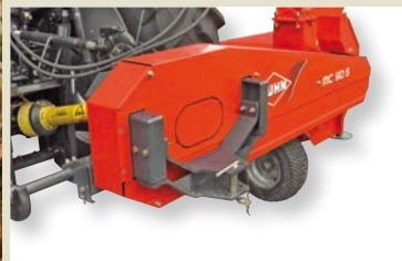
Нижнее положение сцепного устройства (MC 90 S и MC 90 S TWIN).
