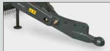
Несколько вариантов исполнения сцепного устройства, включая шаровое сцепное устройство
