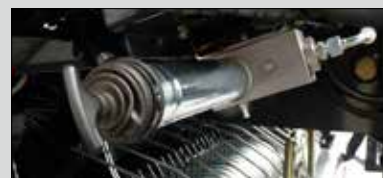
Система автоматической смазки подшипников ВЕКА-MAX
