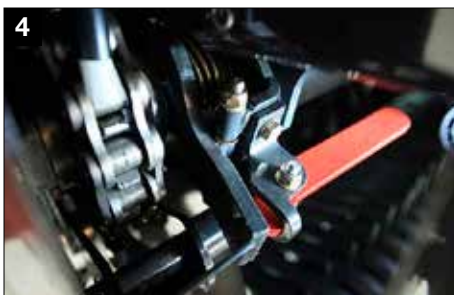
4 Механическое отключение ротора
