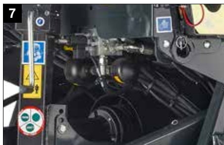
Пропорциональный клапан для контроля плотности из кабины в серийном исполнении
