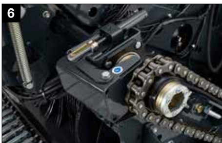
Стандартное гидравлическое отключение ротора
