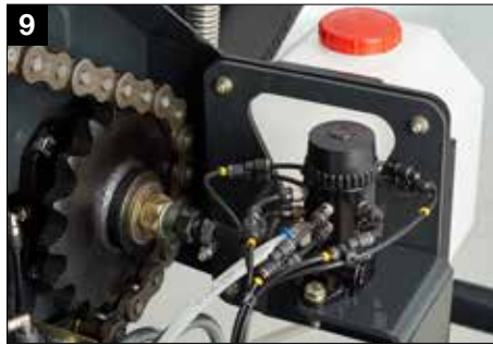
Система непрерывной смазки цепей ВЕКА-MAX
