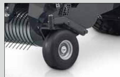
Полупневматические поворотные направляющие колеса
