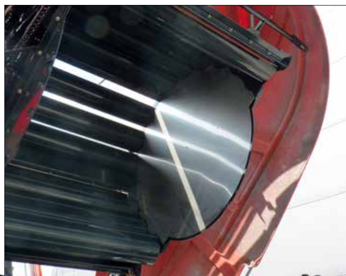
Пластины из нержавеющей стали с низким коэффициентом трения
