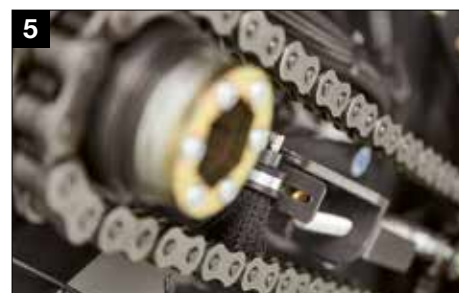
Прочные и широкие кисти обеспечивают идеальную смазку цепей.
