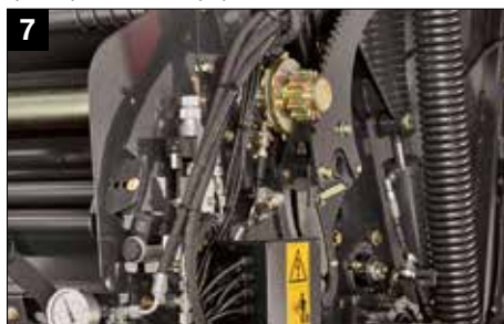
7 Пропорциональный клапан для контроля плотности из кабины
