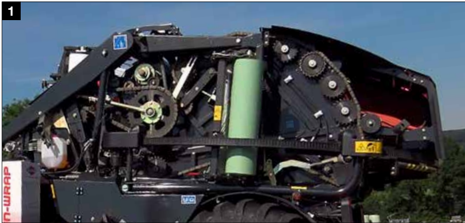
1 Надежный привод с использованием высококачественных цепей IWIS
