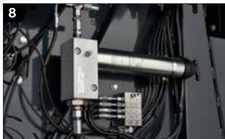
Стандартная система автоматической смазки роликовых подшипников
