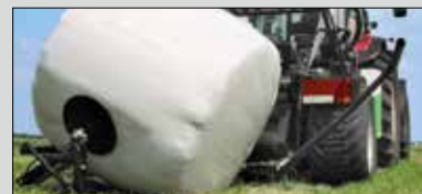
Кантователь тюков, разгрузка тюков на торец
