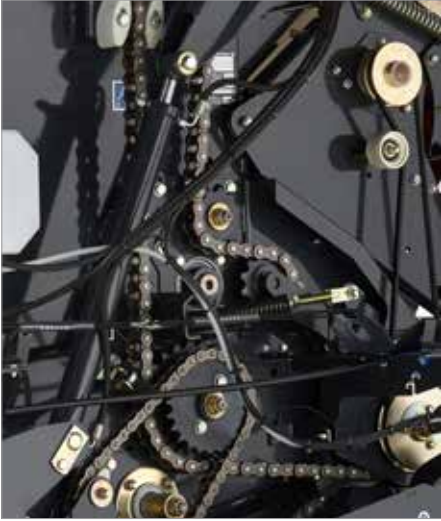
1. Надійний привід з високоякісними ланцюгами IVIS + лінія первинного приводу 1 1/4 дюйма 20BH із хромованими зміцненими зірочками
