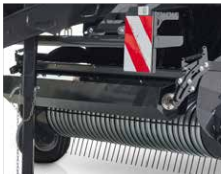
5. Пружинні зубці та важкий ролик (Ø 217 мм) для покращеного попереднього ущільнення й потоку рослинної маси
