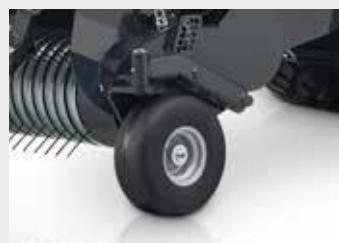
Поворотні напівпневматичні копіювальні колеса підбирача
