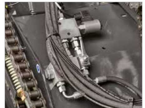
5. Окремі ножі / DROPFLOOR із керуванням із кабіни трактора (додаткове обладнання для OPTIFEED)
