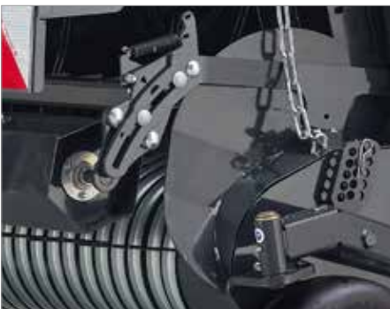
4. Пружинні зубці та важкий ролик (Ø 217 мм) для покращеного попереднього ущільнення й потоку рослинної маси
