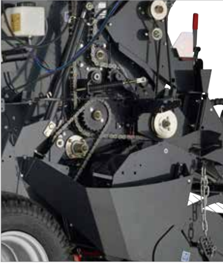
1. Надійний привід із високоякісними ланцюгами IWIS
