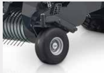
Поворотні напівпневматичні копіювальні колеса підбирача
