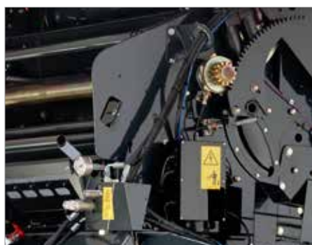
6. Система підвищення тиску PROGRESSIVE DENSITY PLUS
