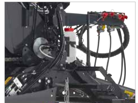
6. Система безперервного змащування ланцюга ВЕКА-МАХ
