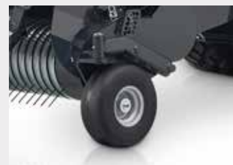
Поворотні напівпневматичні копіювальні колеса підбирача
