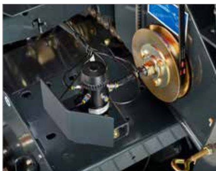
9. Система безперервного змащування ланцюга BEKA-MAX
