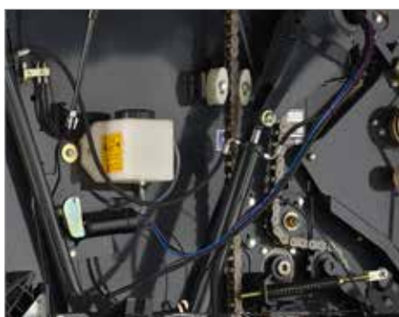
7. Автоматична система змащування ланцюгів
