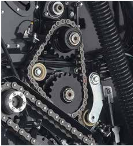
1. Другий приводний ролик гарантує надійність ременного привода за будь-якого стану рослинних мас
