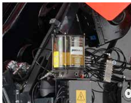
5. Автоматична система змащування
