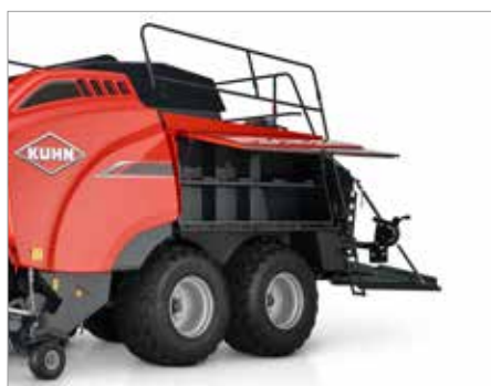
7. Два легкодоступні бокси для зберігання 16 котушок шпагату кожен
