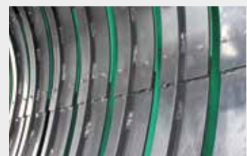
Пластини для кращого проходження потоку до камери попереднього пресування
