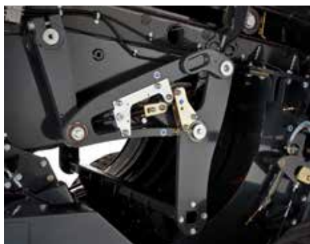
3. Система попереднього пресування POWER DENSITY
