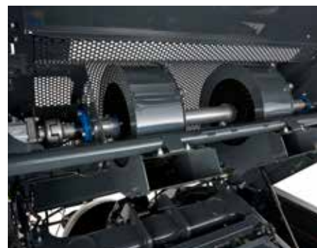
6. Турбіни для очищення вузлов'язальника
