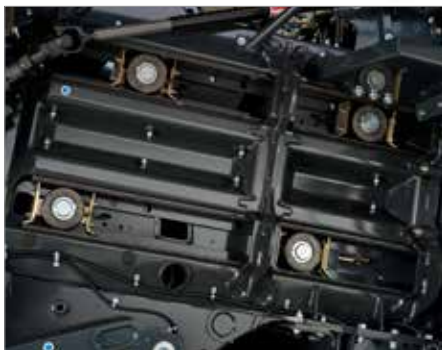
2. Змашчені ролики плунжера для важких умов експлуатації
