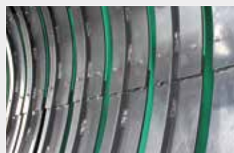
Пластини для кращого проходження потоку до камери попереднього пресування
