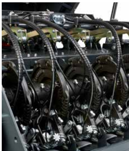
1. Система подвійного обв'язування зі стандартним електронним моніторингом
