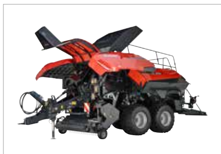
2. Бокси для шпигату повертаються, що спрощує виконання технічного обслуговування
