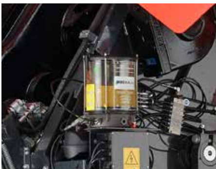
5. Автоматична система змащування
