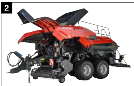
Поворотные шпигатные корпуса упрощают техническое обслуживание
