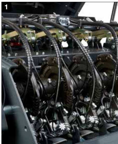
1 Система обвязки двойным узлом со стандартным электронным мониторингом
