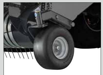
Полупневматические поворотные направляющие колеса блока подбора
