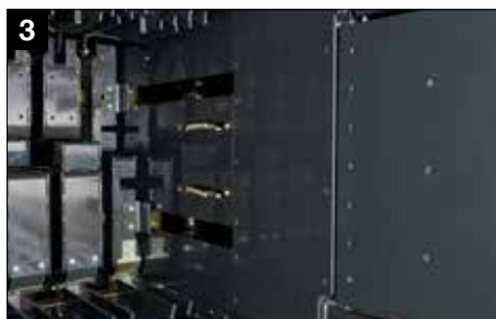
Заменяемые детали тьюкового канала с высокой износостойкостью.
