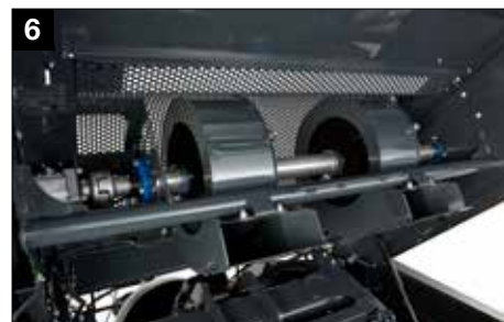
6 Очистные турбины узловязателя
