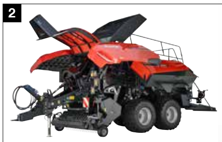
2 Поворотные шпигатные короба упрощают техническое обслуживание
