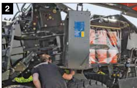
18 Поворотные шпегатные короба упрощают техническое обслуживание
