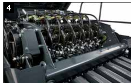
Система обвязки двойным узлом со стандартным электронным мониторингом
