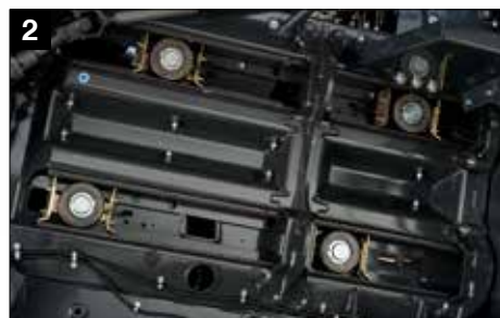
28 Усиленная конструкция — смазываемые ролики поршня
