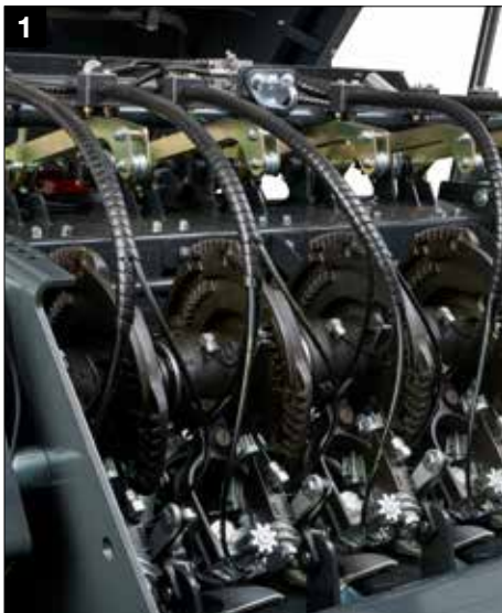
Система обвязки двойным узлом со стандартным электронным мониторингом
