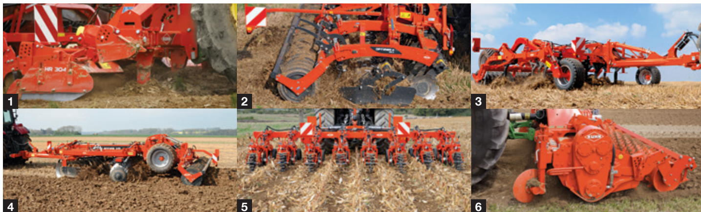
1. Фрезы горизонтальные - 2. Луцильники - 3. Стерневые культиваторы - 4. Дисковые бороны - 5. Орудия для полосовой обработки - 6. Фрезы вертикальные
